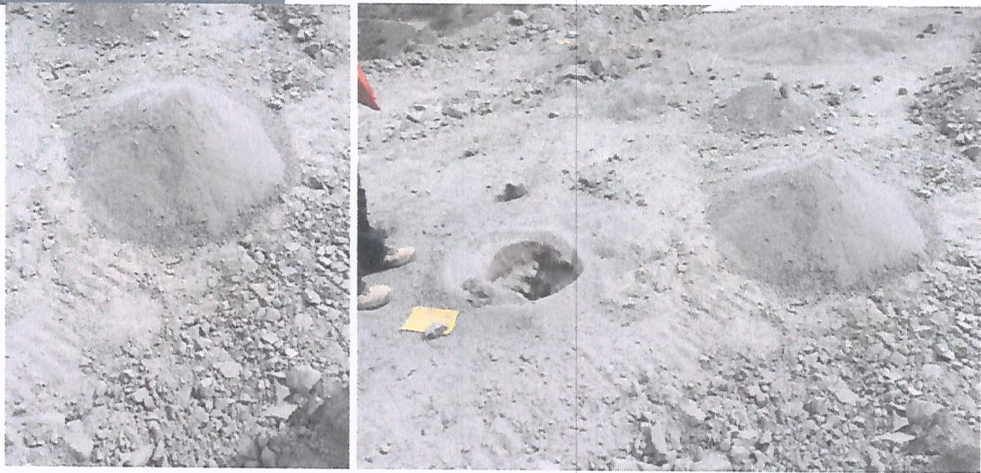
Imagen 3. Material utilizado como taco en tronaduras.
